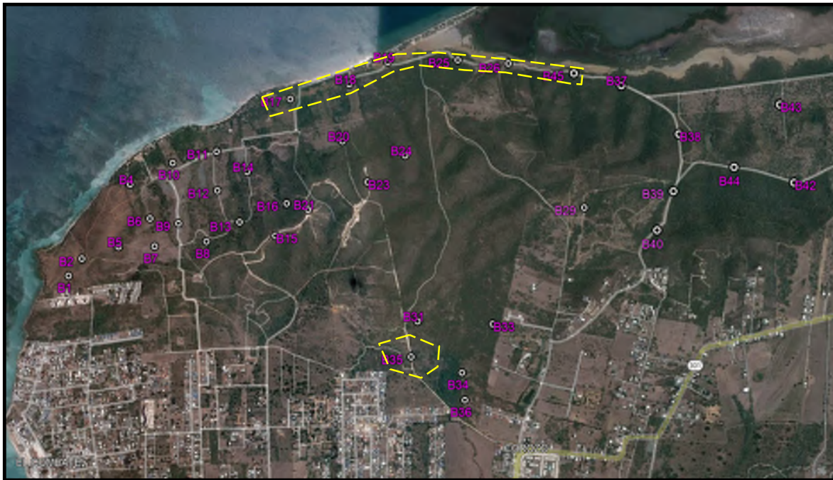
Figura 6. Las áreas punteadas indican la presencia de suelos aluviales de capacidad portante media/marginal.
